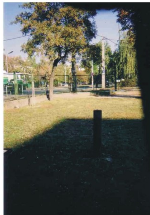
A keserűvízes aknakutak helyén található talajvízszint-észlelőfürás
